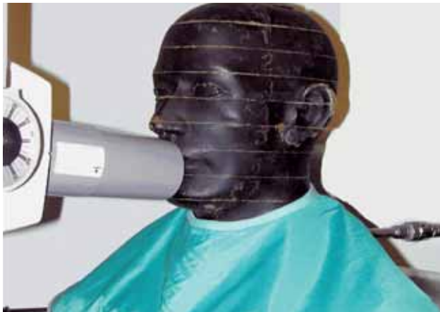
Abb. 3 Messaufbau für die Bestimmung der Schilddrüsendosis unter Verwendung einer Halbschürze (0,5 mm Pb).
