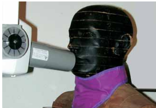
Abb. 2 Messaufbau für die Bestimmung der Schilddrüsendosis unter Verwendung eines Halskragens (0,5 mm Pb).
