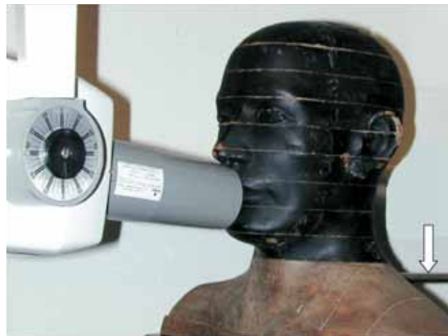
Abb. 1 Messaufbau für die Bestimmung der Schilddrüsendosis ohne Schutzmittel. Unten rechts ist ein Teil der Ionisationskammer sichtbar (Pfeil), die im Hals-Schulter-Teil aus Masonit bis an den Ort der Schilddrüse eingeführt ist.
