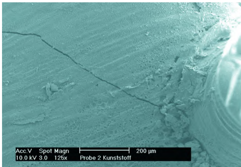
Abbildung 9 Bruchlinie im Aufbau ausgehend von einer parapulpären Schraube, Vergrößerung 125fach.
