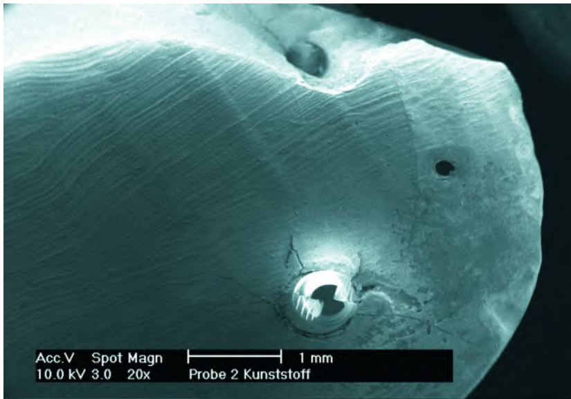
Abbildung 6 Bruchfläche im Kompositaufbau mit Ausbruch einer parapulpären Schraube und Bruchlinien ausgehend von einer Schraube, Vergrößerung 20fach.
