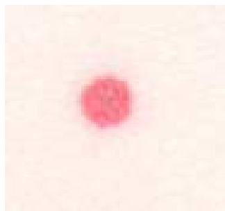
Abbildung 16: Punktkontakt Durchmesser 5 mm auf Druckmessfolie (stark vergrößert)
