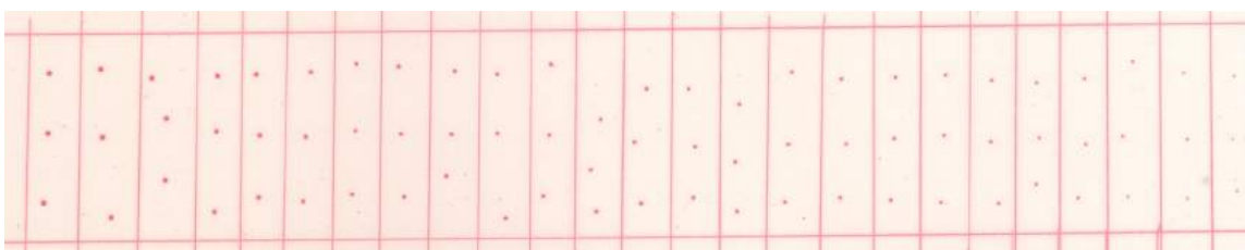
Abbildung 25: Druckmessfolie (PVAC beschichtet) mit Messreihe (Kugeldurchmesser 2,5 mm)
